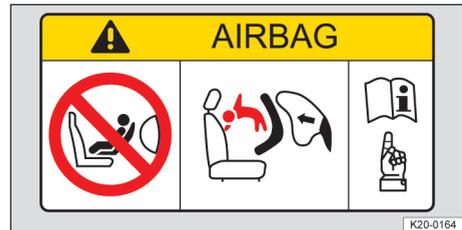
Fig. 1 Autocollant du sac gonflable sur le pare-soleil (schéma de principe)
