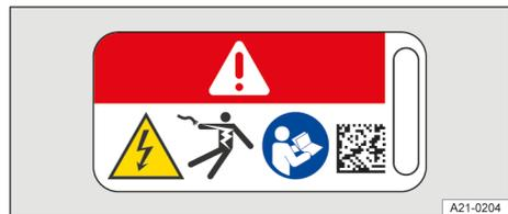
Fig. 4 Plaquette d'avertissement sur les composants haute tension
